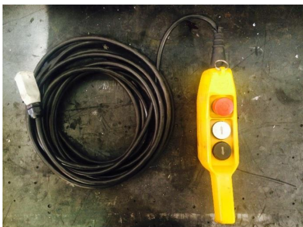
Рис. 1 – Кнопочный пульт для испытания парашютного тормоза
