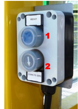
Рисунок 7 – Кнопочный пульт управления прямым спуском
