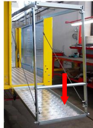
Рисунок 21 - Площадка для монтажа настенных опор
